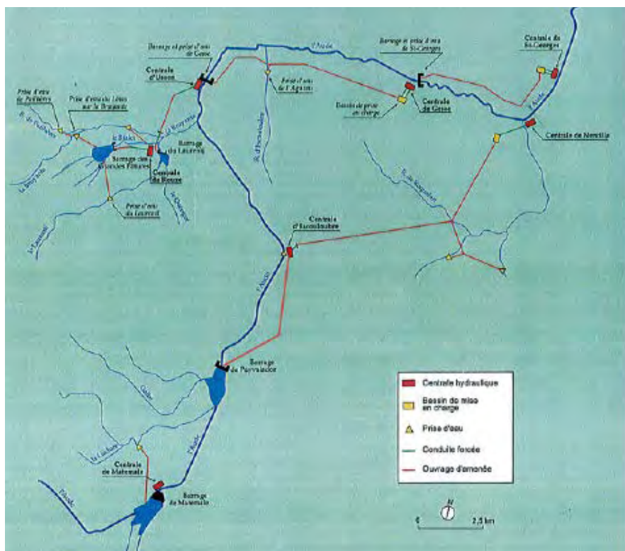
Infrastructures hydroélectriques EDF à l'amont d'Axat
